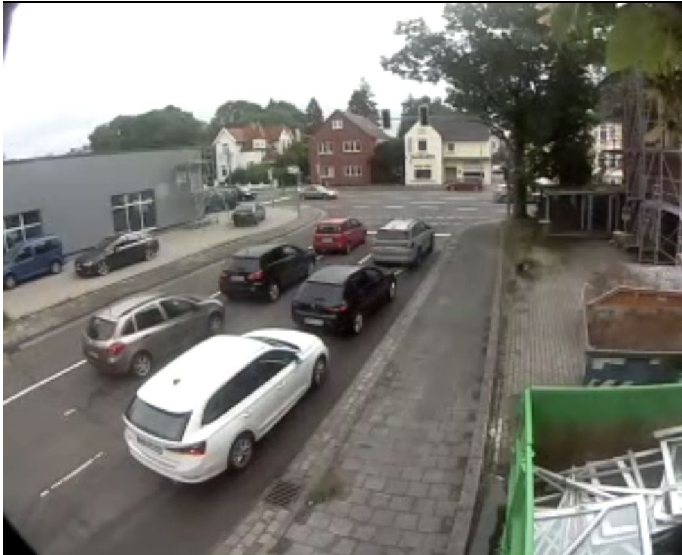
Abb. 6.1 Rückstausituation in der Knotenzufahrt der Schützenstraße zur Esenser Straße (B 210) mit separaten Fahrstreifen für den Rechts- und Linksabbieger
